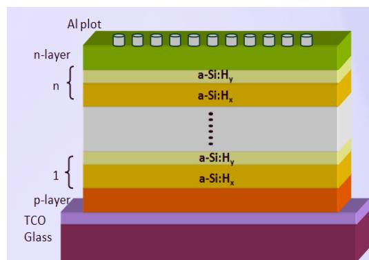
a-Si:H<sub>x</sub>/a-Si:H<sub>y</sub> 超晶格矽薄膜太陽電池結構圖
