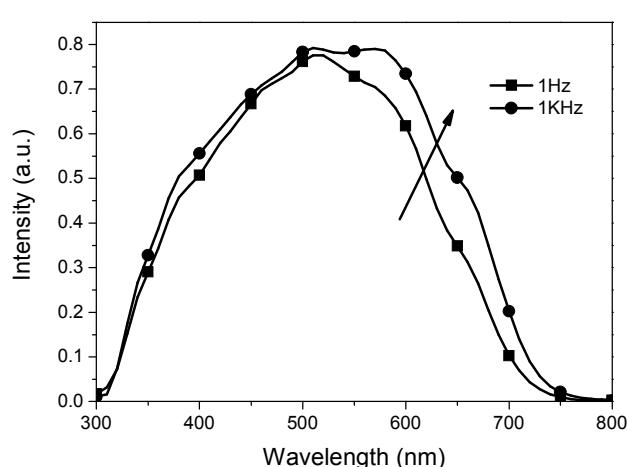
以脈波電漿頻率1 Hz及1 kHz製作的a-Si:H薄膜太陽電池QE曲線
